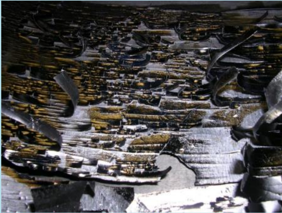
Лист вольфрама после многократного облучения плазменным потоком в выходном узле многопробочной ловушки ГОЛ-3. Пресс-служба Института имени Будкера СО РАН
