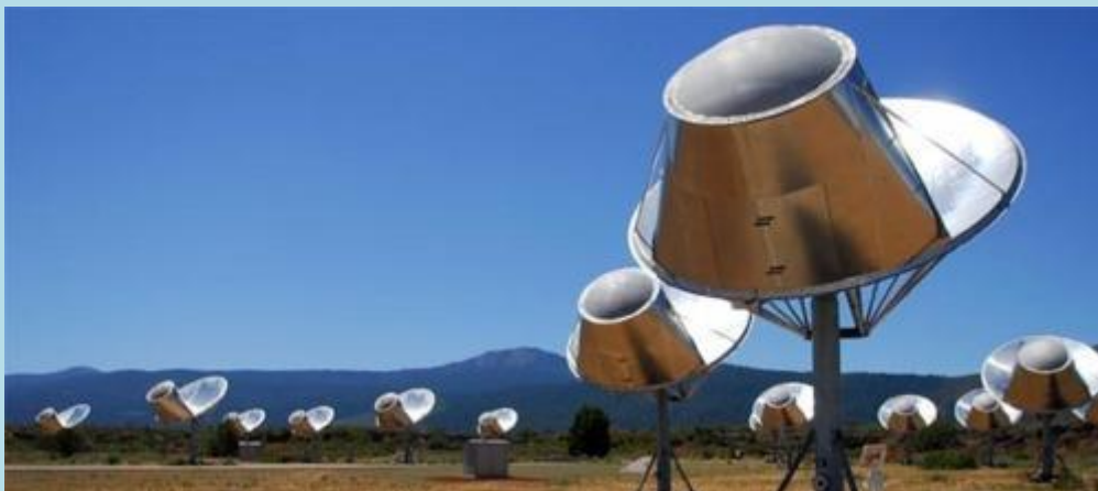
Радиотелескоп АТА-42, состоящий из 42 одинаковых шестиметровых параболических антенн. Источник фотографии.
