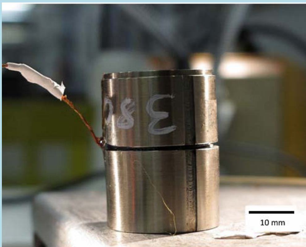
Два образца с проводами, подсоединенными к датчикам Холла
