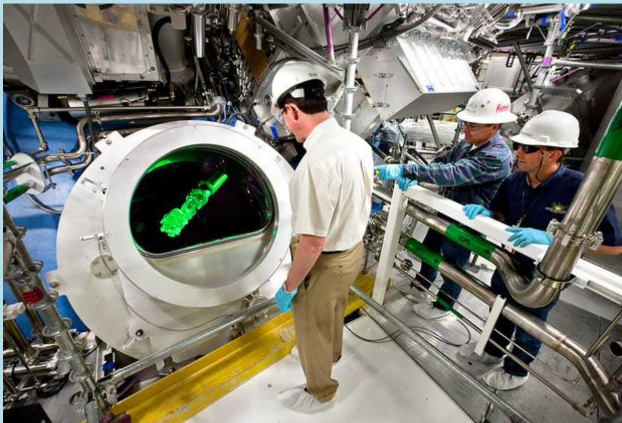
Окно, через которое можно заглянуть в реакционную камеру
