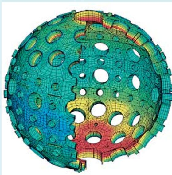
**Внутренний разрез алюминиевой оболочки камеры для лазерного термояда. Показаны отверстия, через которые на мишень с термоядерным топливом будут направляться лазерные пучки.**
