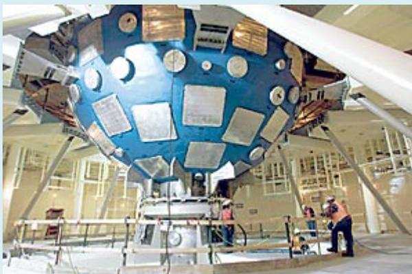
**Самым продвинутым на сегодняшний день проектом лазерного термояда считается американский NIF, реализуемый в Ливерморской национальной лаборатории. На снимке – пятиметровая камера, внутри которой будут происходить термоядерные микровзрывы.**
